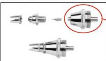
従来のヘッドと異なるノズルベースは圧縮空気の流れを考慮し空気経路を3つ穴にし、空気を分散させることより、高微粒化の吹付けを可能にしました。ノズルヘッドシステムは4点の部品で構成され、何度も吹付けテストを行い、ベストコンディションになるまで微調整を行っています。部品交換の際は、ヘッドセット(4点の部品)で交換することをお勧めいたします。ノズル口径は最も小さい0.18mmと0.23mmの2種類。極上のファインラインをお楽しみください。
